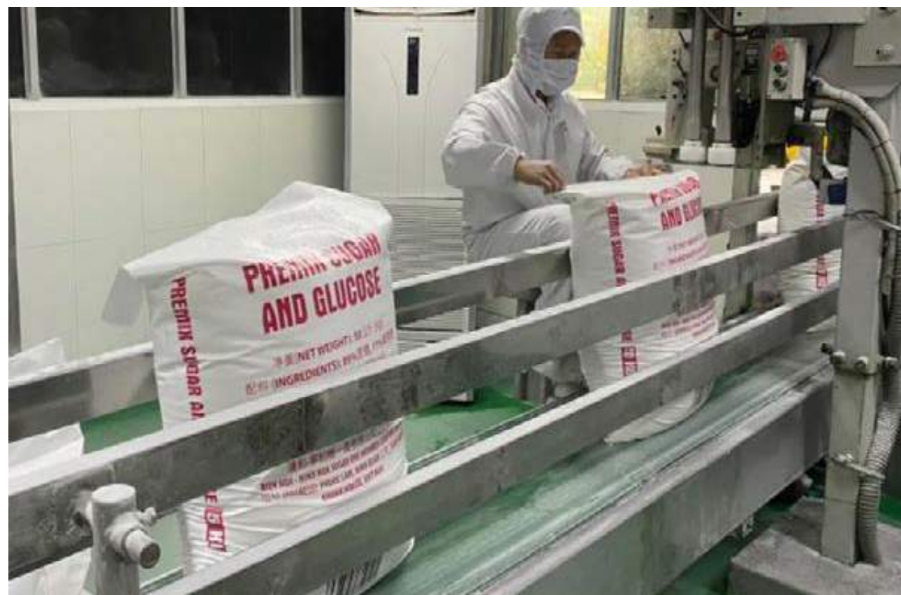
Thiết bị cân đóng bao 50kg phục vụ cho đơn hàng Đường Mix
