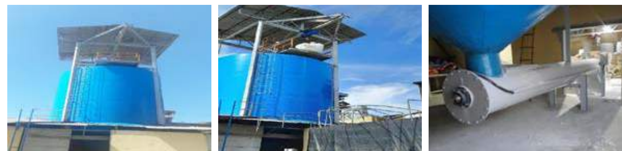
Hệ thống tiếp nhận vôi bao Bigbag tại Nhà máy Biên Hòa - Ninh Hòa
